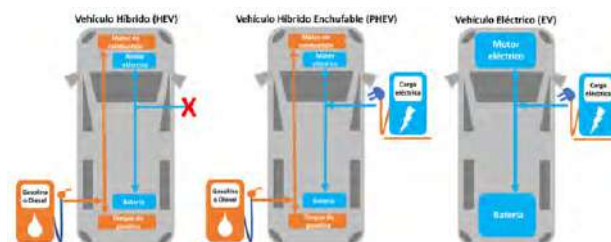
Figura 2. Tipos de vehículos eléctricos: Híbridos HEV, Híbridos enchufables (PHEV) y Eléctricos puros (EV). Elaboración propia.
