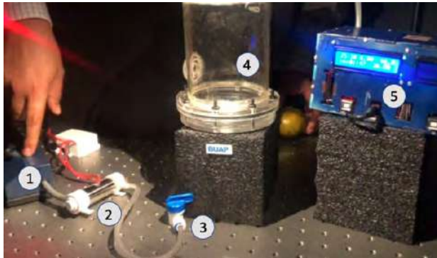
Figura 5. Configuración experimental, con los elementos (1) bomba de aire que introduce aire en el (2) generador de ozono y pasa por una (3) válvula para introducir el O 3 en el (4) recipiente cerrado. Por último, a través de una manguera se conecta un sensor de partículas (PM 10 y PM 2.5 ). Fotografía del experimento elaborado en el Laboratorio de interferometría holográfica de la BUAP.
