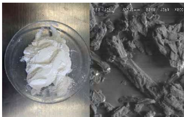
Figura 6. Presentación del compuesto celulósico. A) Observación macroscópica B) Observación microscópica en MEB (500X). (Elaboración propia).
